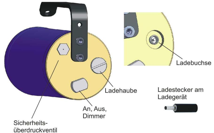
1. Inbetriebnahme der Lampe: Die Lampe wird durch eine Rechtsdrehung des Drehknopfes „An, Aus, Dimmer“ angeschaltet, der auch an den seitlichen Abflachungen zu erkennen ist. Hiermit wird gleichzeitig der Dimm-Mechanismus betätigt. Die Lampe beginnt mit der kleinsten Stufe, durch weiterdrehen nach rechts erreicht die Lampe die hellste Einstellung am Anschlagpunkt des Knopfes.
