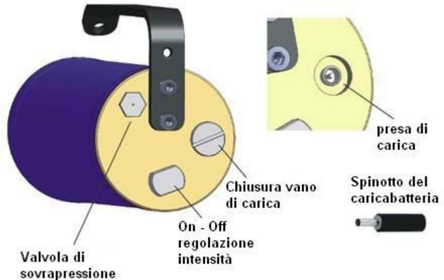
1. Accensione della torcia: L'accensione della lampada avviene attraverso la rotazione in senso orario dell'interruttore d'accensione, riconoscibile grazie ai lati appiattiti. La lampada si accende con l'intensità minore, continuando a girare in senso orario l'intensità luminosa aumenta fino a raggiungere il massimo a fine corsa dell'interruttore. Per spegnere la torcia, girare l'interruttore in senso antiorario fino all'arresto.
