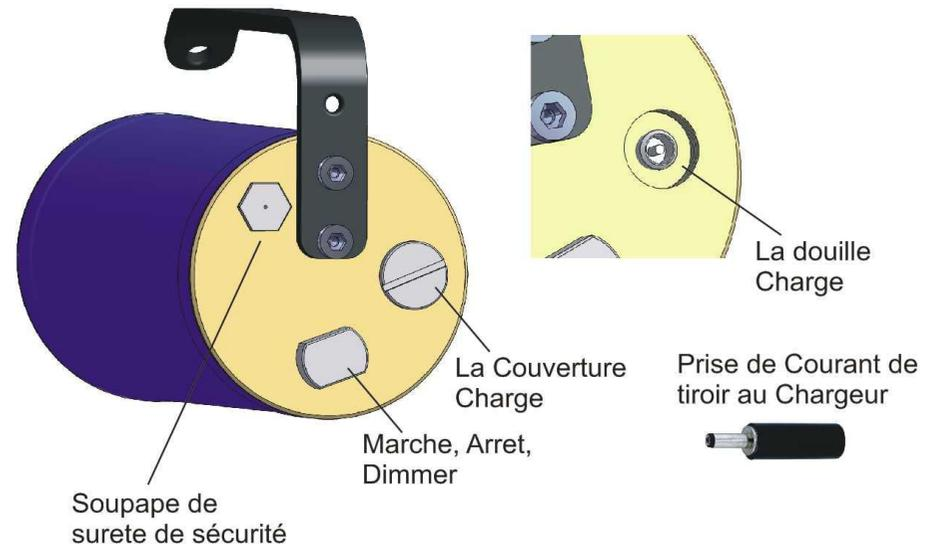
1. Démarrage de la lampe : L' allumage de la lampe se fait grace au bouton rotai f <<Marche>> avec les aplatissement latéraux. Par une rotation à droite, la lampe se met en circuit. De cette manière le Dimm-Mechanismus est actionné aussi en même temps. La lampe commence avec la plus petite étape, continuer à tourner vers la droite la lampe atteint le réglage le plus lumineux jusqu'au levage de point du buoton.
