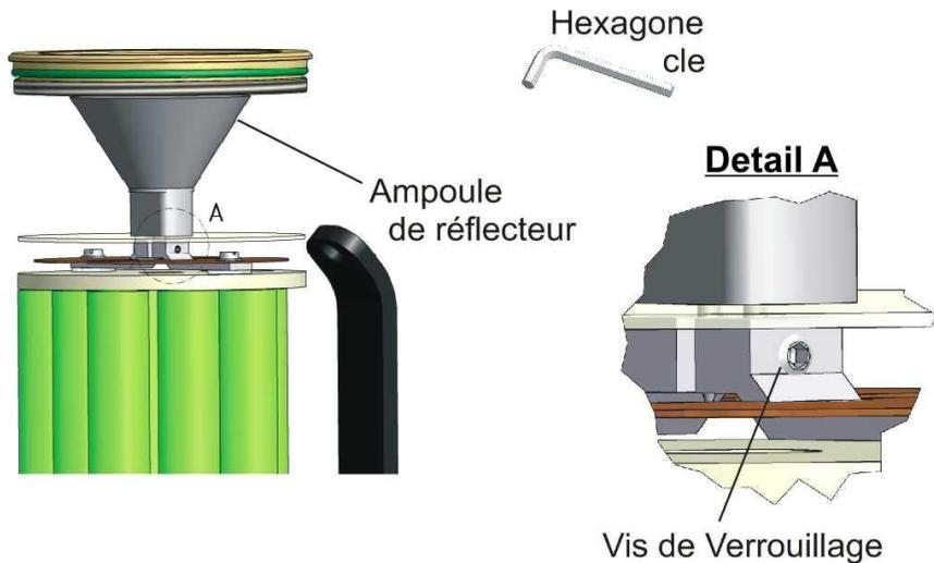
3. Échange ala lampe de réflecteur : Pour échanger de la lampe de réflecteur, le logement doit être ouvert. Cela est possible, si la couverture arrière, Se trouve un maintien, ces: S'ouvre avec un mouvement vers la gauche.
